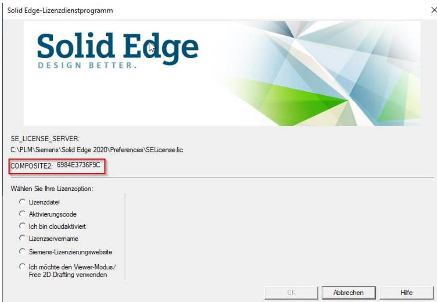
Den Wert Composite2 zur Erstellung des Computers in der Lizenzverwaltung auf GTAC notieren. (oder später mit Copy and Paste einfügen)
