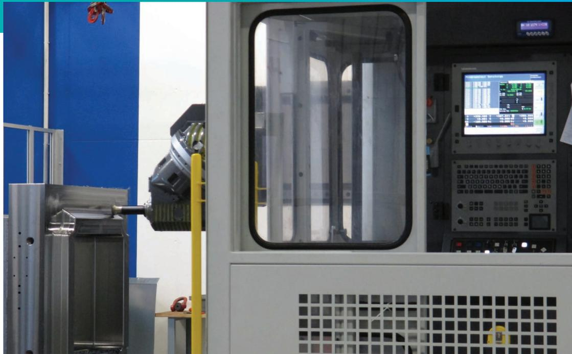
*Die Drahterosion wurde weitgehend durch Hochgeschwindigkeitszerspanung mittels leistungsfähiger, hochpräziser Drei- und Fünfachs-Maschinen ersetzt.*
