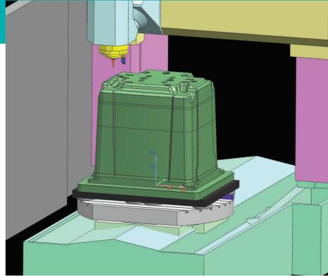
Hochgeschwindigkeitszerspanung mit leistungsfähiger und hochpräziser Drei- und Fünfachs-Maschinen hat die Verwendung von EDM teilweise ersetzt. Zur Programmierung dieser komplexen NC-Maschinen wird NX CAM eingesetzt, die zudem erweiterte Simulations- und Verifizierungsmöglichkeiten und feature-basierte Fertigung für die Automatisierung der NC-Programmierung bietet.
