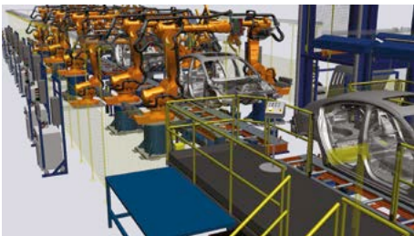
Validierung der konstruierten Fertigungsstraßen mit Process Simulate
