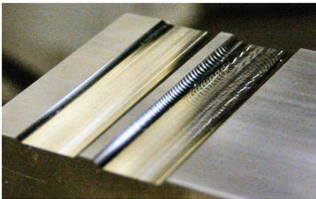
Abbildung 1: Zwei Schnittbahnen, eine mit gleichmäßigen Bearbeitungsbedingungen und eine mit Ratterschwingungen.
