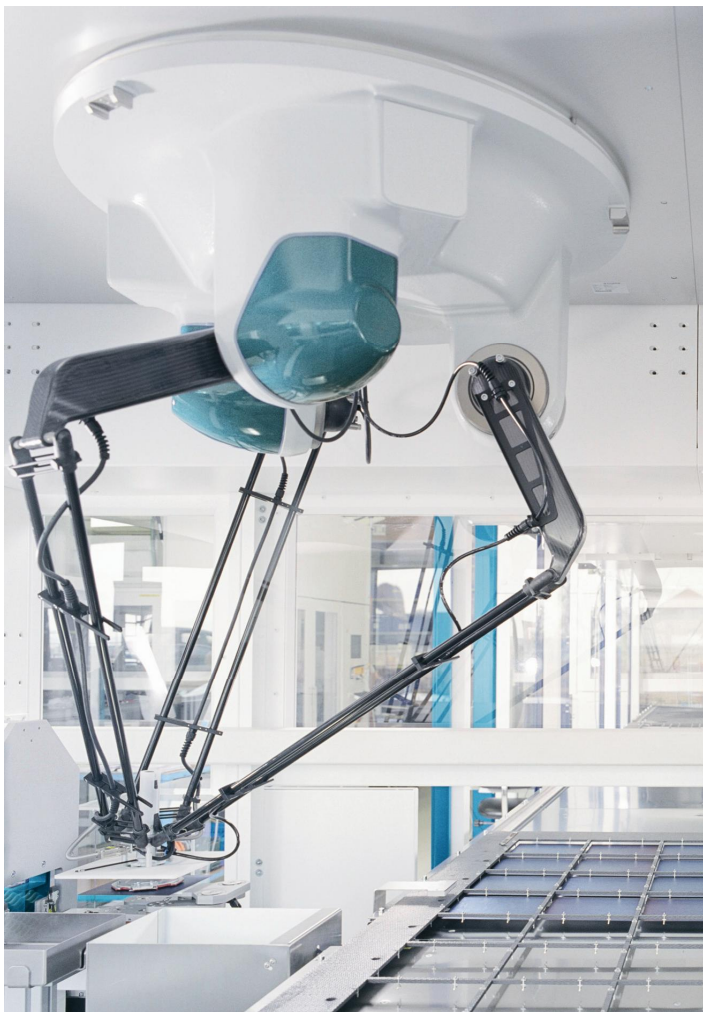
Bildunterschrift: Be- und Entladezelle mit DELTA-Kinematik (Foto: Manz Automation)
