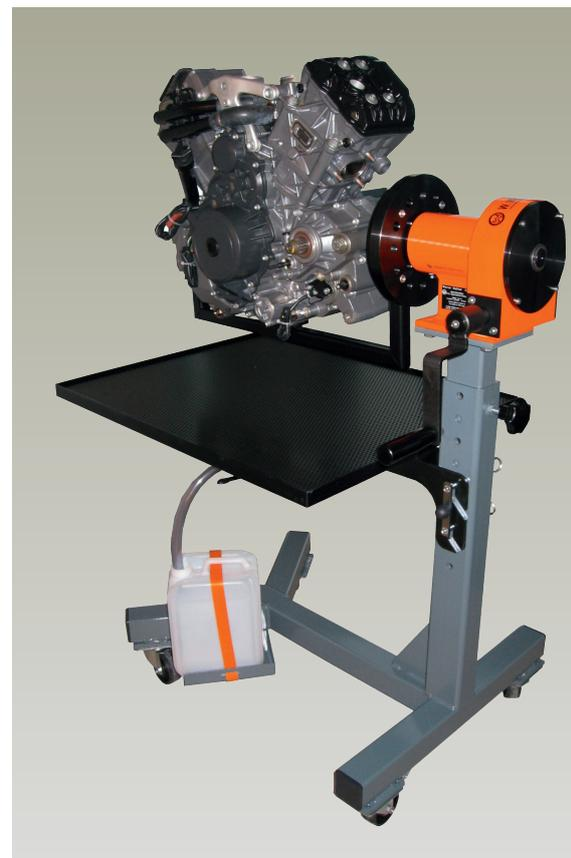
Motor-Getriebe-Reparaturstand für Motorrad-Werkstätten
