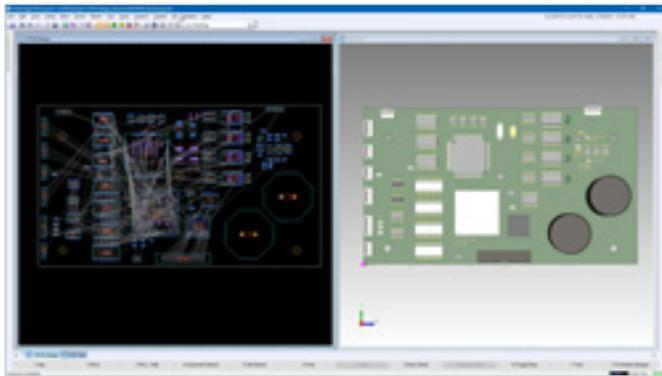
onen werden in einer nahtlosen ECAD-MCAD-Umgebung erstellt. Änderungen werden in beiden Bereichen interaktiv hervorgehoben, wodurch Konstruktionsfehler minimiert und die Entwicklungszeit verkürzt wird.
