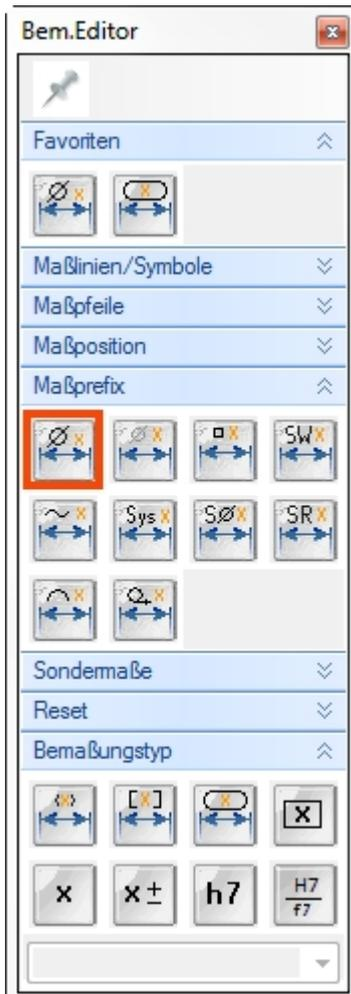
Die unterschiedlichsten Maßdarstellungen können in Solid Edge durch entsprechende Einstellungen im Bemaßungsmenü eingestellt werden. Häufig sind es mehrere Werte, die eingestellt werden müssen, um die gewünschte Darstellung zu bekommen. Mit dem Bemaßungseditor erledigen Sie all diese Dinge mit einem einzigen Klick.
