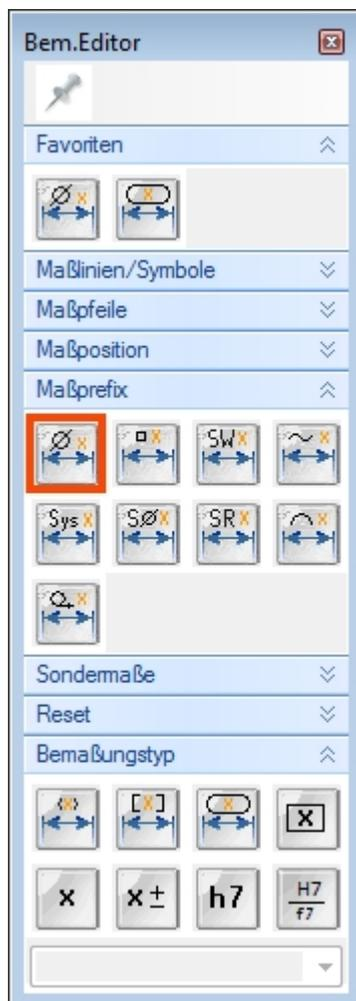
Die unterschiedlichsten Maßdarstellungen können in Solid Edge durch entsprechende Einstellungen im Bemaßungsmenü eingestellt werden. Häufig sind es mehrere Werte, die eingestellt werden müssen, um die gewünschte Darstellung zu bekommen. Mit dem Dimension Editor erledigen Sie all diese Dinge mit einem einzigen Klick.
