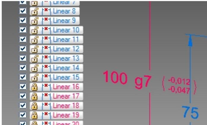
Die Zeilen mit Haken in den Kontrollkästchen der ersten Spalte (Filter) werden hellblau hinterlegt. Nur die Maße dieser Zeilen werden in dem erzeugten CAD Modell verändert. Über die Funktionen in "Export Filter" können Sie die Zeilen automatisch auswählen lassen.
