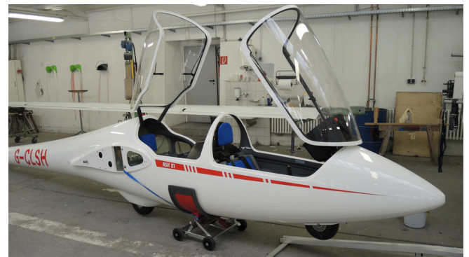
Die moderne Bauweise in GfK und Epoxidharz setzt exakte Formen voraus, die im CAD definiert wurden
