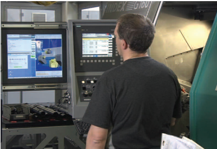
Abbildung 7: Maschinenbediener können NC-Programme und die Einrichtung der Maschine für den nächsten Arbeitsauftrag mithilfe der Virtual Machine prüfen, ohne die echte Werkzeugmaschine dadurch zu blockieren.
